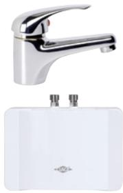
Petit chauffe-eau instantané électrique avec robinet mitigeur basse pression pour l'alimentation économique en eau chaude d'un lavabo entre environ 35 °C à 50 °C. L'eau est chauffée directement pendant son écoulement, ce qui supprime les pertes thermiques et permet de disposer d'eau chaude à tout moment. Le mitigeur de haute qualité à encastrer est équipé de tuyaux de raccordement flexibles pour faciliter son installation. Un vidage à tirette est disponible en option pour un confort optimal.
